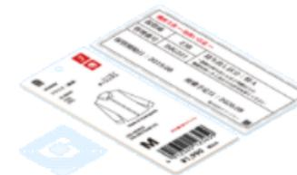
店舗の棚卸・在庫管理の運用されているRFID値札タグをそのままセキュリティタグとして流用可能。発報対象のEPCコードをゲート側に設定し、アラームの運用を実現
